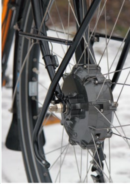
Bitte wie abgebildet, nur Tacho mit Kabelverbindung montieren. Ein Funktacho verursacht Störungen im Antrieb.
