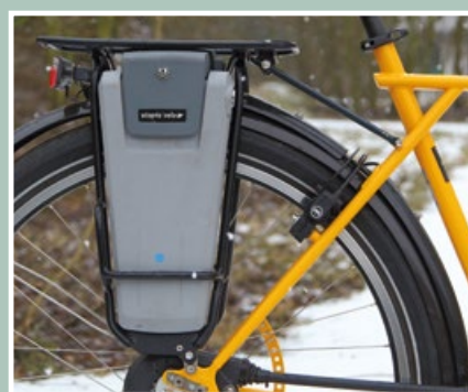
Der wasserdichte Batteriebehälter kann von der Steuerungseinheit (Controller) getrennt und abgenommen werden, ohne dass Sie einen Stecker ziehen müssen. Er ist mit einem Schloss gesichert. Das dient der sicheren Befestigung am Rad, ist aber kein Schutz vor Diebstahl.
