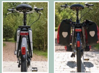
Die schmalen Batteriebehälter machen es möglich: Sie können Ihre (Ortlieb) Taschen wie gewohnt am Tubus Träger einhängen.
